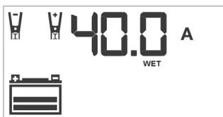
La Pantalla Digital muestra la corriente de salida que está cargando la batería. Los íconos de Abrazadera y el Indicador de Tipo de Batería se iluminan fijos, así como las barras de la Batería. El ícono cambiará de vacío a sólido (de abajo hacia arriba) para indicar que la unidad está en modo de carga
