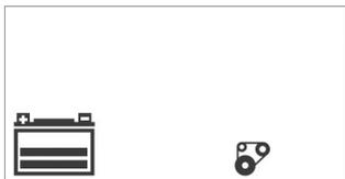
El Icono del Alternador parpadeará y el Icono de la Batería con dos barras se iluminará de forma fija.
