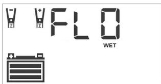
La pantalla digital muestra "FLO", lo que indica que la unidad está en Modo de Carga Flotante. Los íconos de Abrazadera, el ícono de Batería (con tres barras) y el Indicador de Tipo de Batería se iluminarán de manera fija.
