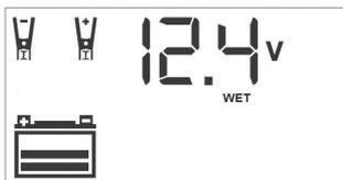
La Pantalla Digital muestra el voltaje de la batería conectada. Las barras en el Icono de la Batería representan el nivel de carga de la batería conectada. Los Iconos de Abrazadera, el Icono de Batería y el Indicador de Tipo de Batería se iluminan de manera fija.
