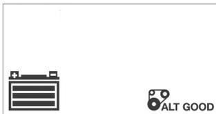
El Icono del Alternador, "ALT GOOD" y el icono de la Batería (completa) se iluminarán de manera fija.
