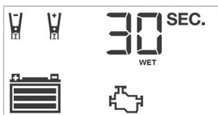
El ícono del Motor de la Bomba parpadeará. La Pantalla Digital muestra un conteo regresivo para indicar que la unidad está en Modo de Arranque del Motor. Las barras del ícono de la Batería cambiarán de vacías a sólidas (de abajo hacia arriba) repetidamente. Los íconos de Abrazadera, el Indicador de Tipo de Batería y el ícono de Batería se iluminarán de manera fija.
