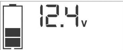
Las barras en el ícono del Estado de la Batería representan el nivel de carga de la batería interna de la unidad. Las barras en el ícono del Estado de la Batería cambiarán de vacías a sólidas (de abajo hacia arriba) repetidamente para indicar que la unidad se está cargando. La luz de fondo se encenderá durante 10 segundos (solamente).
