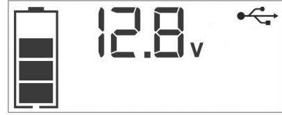
El ícono de Estado de la Batería y el Indicador de Voltaje de la Batería se iluminarán de manera fija, así como el ícono USB, lo que indica que los puertos USB están listos para usarse.
